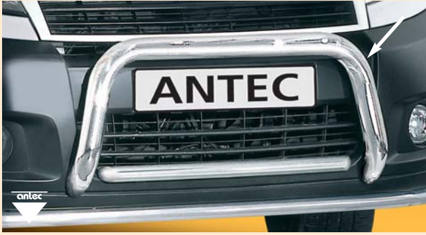
EU-pedestrian protection guard 60mm high (EU-certificate also valid in combination with 12F4041 or 12F4085) AV. Kis,i Korumas? 60 mm-yüksek (AB sertifikas? 12F4041 or 12F4085 ile de geçerlidir) Stainless steel / Paslanmaz Çelik 12F 4013
